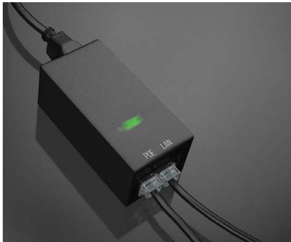
El transformador es el dispositivo de color negro con una luz verde o blanca en la parte superior, el mismo tiene dos cables de datos conectados (POE y LAN) y uno de energía eléctrica.
