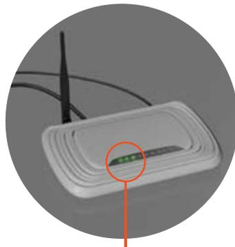
Luces de encendido y estado del router.
